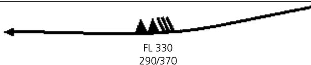
Posizione, quota, direzione e velocità del vento nel cuore della corrente a getto (Jet Stream Core). Inizio e fine in corrispondenza delle zone dove è attesa una velocità  $\geq 80$ KT. Nel caso di velocità  $\geq 120$ KT si può indicare anche l'estensione verticale della isotaca di 80KT al di sopra e al di sotto del cuore della corrente a getto (qui 290/370).
