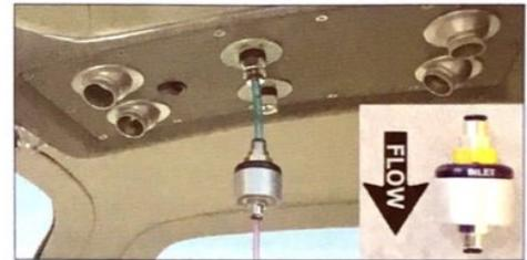
Les buses de distribution d'oxygène sont placées de manière à être facilement utilisables. La bouteille est placée dans le fuselage et se remplit par un orifice extérieur.
